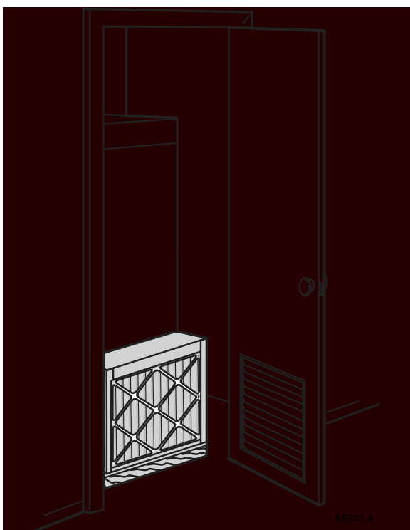
Fig. 3. Chaudière superposée avec installation dans un placard. L'épurateur d'air électronique se monte verticalement sur la chaudière entre cette dernière et l'ouverture de l'air de retour à volets de la porte du placard.
