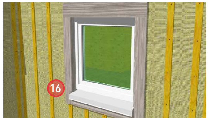
16. Install window trim.
