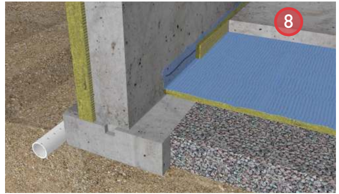
8. Place reinforcing and pour slab-on-grade concrete.
