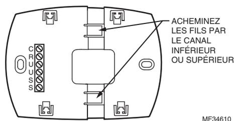
Acheminez les fils par le canal supérieur ou inférieur sur la plaque arrière pour un montage en gaine. Pour une installation similaire à un thermostat sur le mur, acheminez les fils par l'arrière.
