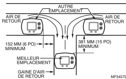
**Avertissement :** Le produit doit être monté sur le côté **RETOUR** de la gaine pour assurer une détection adéquate de l'humidité relative.
