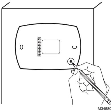
Tenez la plaque murale à l'emplacement désiré sur la gaine et tracez un repère à l'intérieur de l'orifice du tube de la gaine.
