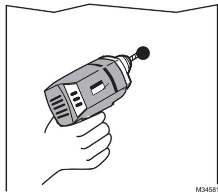
Trouvez le repère et percez un orifice de 12,7 mm (1/2 po) dans la gaine. Ceci est l'endroit où le tube de la gaine sera inséré pour capter l'air.
