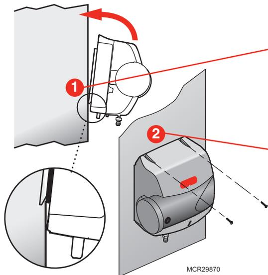
Attachez les crochets de support des modèles à dérivation sur le bord inférieur de l'orifice.
