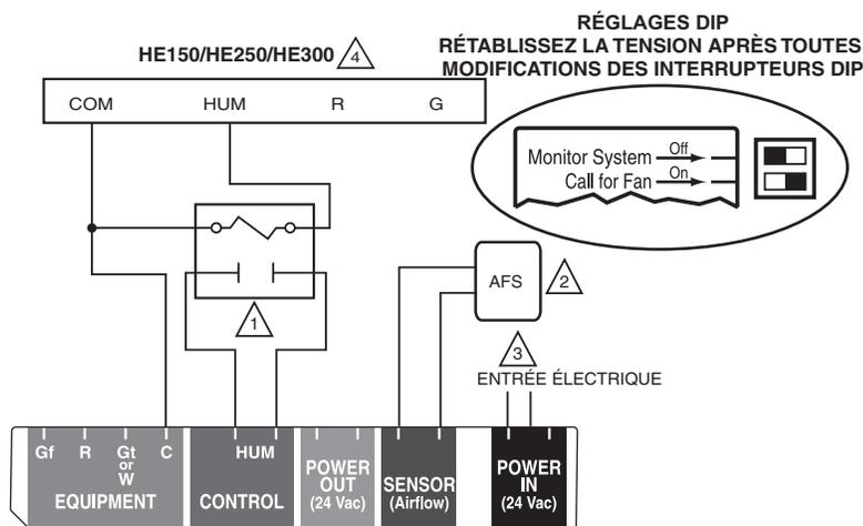
1 AJOUTEZ UN RELAIS D'ISOLATION DE 24 V C.A. (TEL QUE LE R8222B1067) ENTRE L'HUMIDIFICATEUR ET LE SYSTÈME DE TRAITEMENT DE L'AIR.
