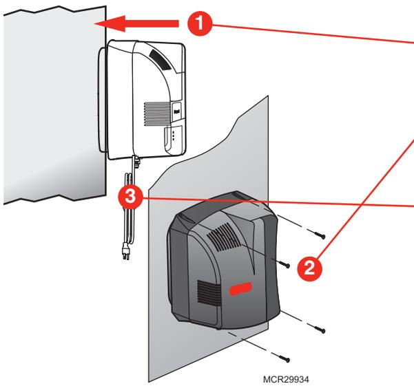
Faites glisser le modèle à ventilateur uniformément dans l'orifice de la gaine. Vérifiez que l'humidificateur est à niveau.
