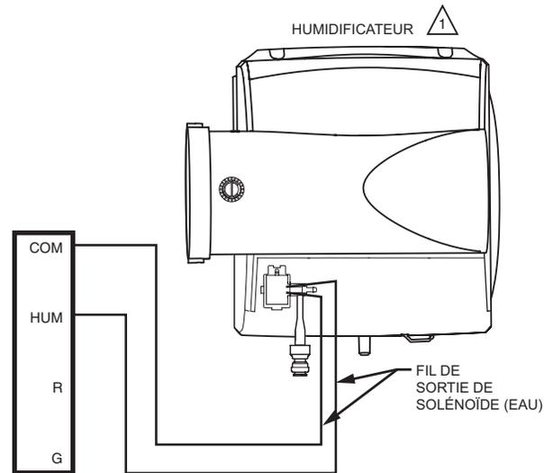
1 LE SCHÉMA DE CÂBLAGE SUPPOSE L'UTILISATION D'UN THERMOSTAT COMMUNIQUANT SPÉCIFIQUE À L'ÉQUIPEMENT POUR CONTRÔLER L'HUMIDIFICATEUR.
