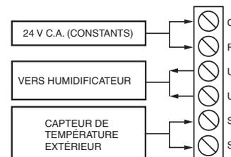
REMARQUES : LES BORNES C ET R DOIVENT AVOIR 24 V C.A. CONSTANTS! CÂBLAGE SUR LE TABLEAU DE CONTRÔLE DE L'APPAREIL DE CHAUFFAGE/DE TRAITEMENT DE L'AIR.
