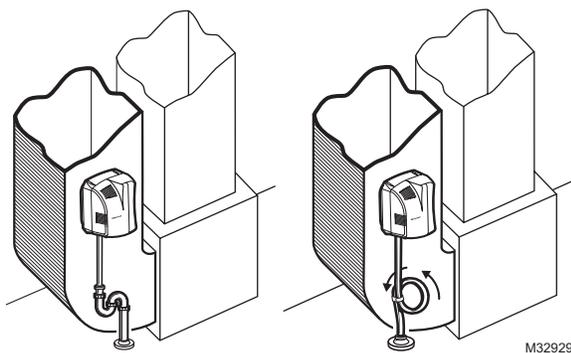
Si une gaine de retour doit être installée, un collecteur doit être installé dans le tuyau de vidange. Un vrai collecteur est recommandé, mais une boucle dans le tuyau fixée avec un ruban ou une attache est également acceptable.
