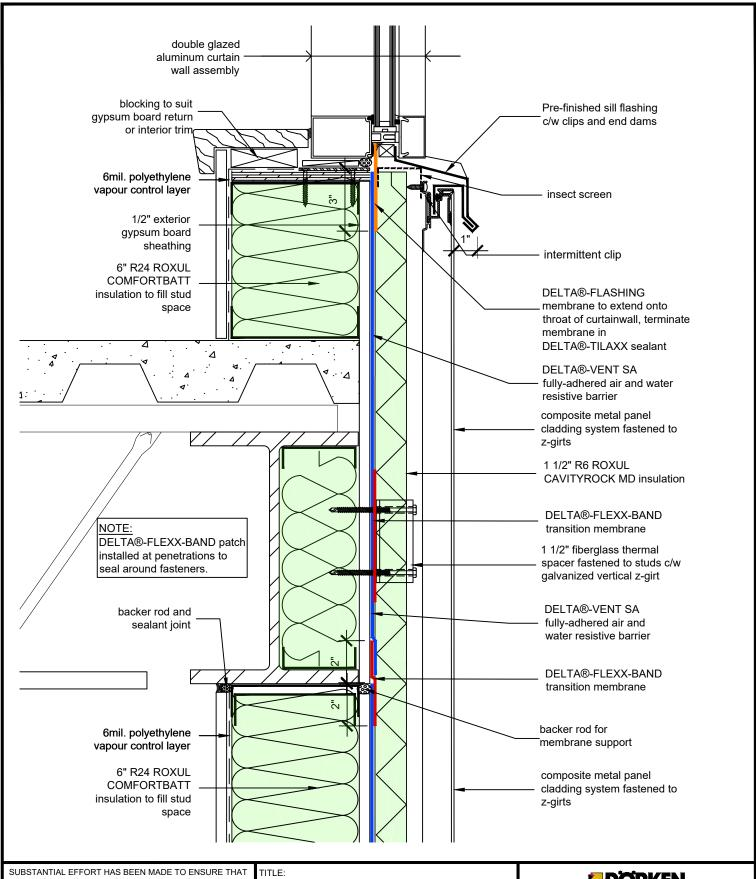
WALL ASSEMBLY #1: TYPICAL CURTAIN WALL SILL
