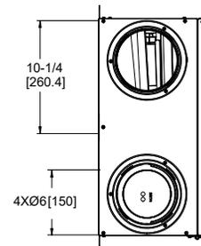
9" / 22.9 CM CLEARANCE REQUIRED FROM DOOR SURFACE FOR MAINTENANCE
